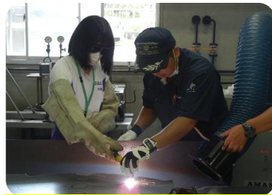
プラズマ切断
