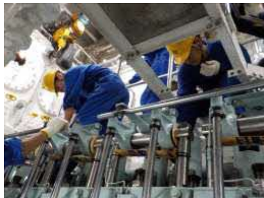
11月12日 機関科の生徒は主機の燃料噴射弁の交換作業をしました。
